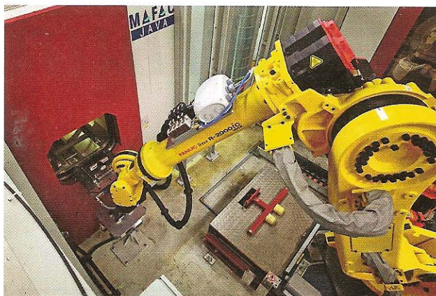
Ein palettiertes Werkstück wird in die Waschanlage von Mafac eingebracht.
