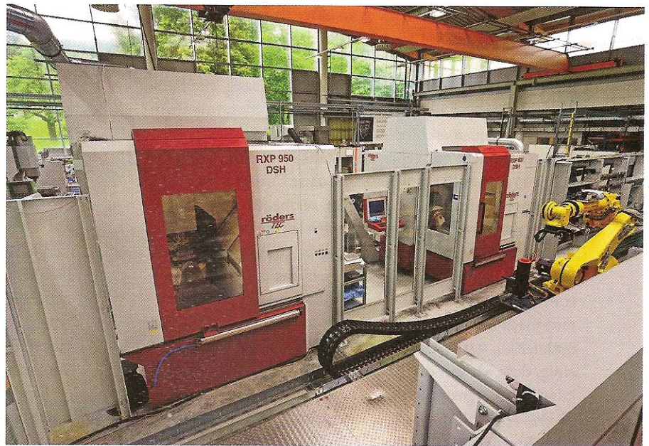
Kernkomponenten der Zelle sind zwei Röchling-HSC-Fräs-BAZ und ein Handlingroboter auf einer Linearschiene. Letzterer bedient drei Werkzeugmaschinen, die Koordinatenmessmaschine und die Waschanlage. Material, Paletten und Werkzeug sind in Regalen aufgereiht. (Bilder: Klaus Vollrath)
