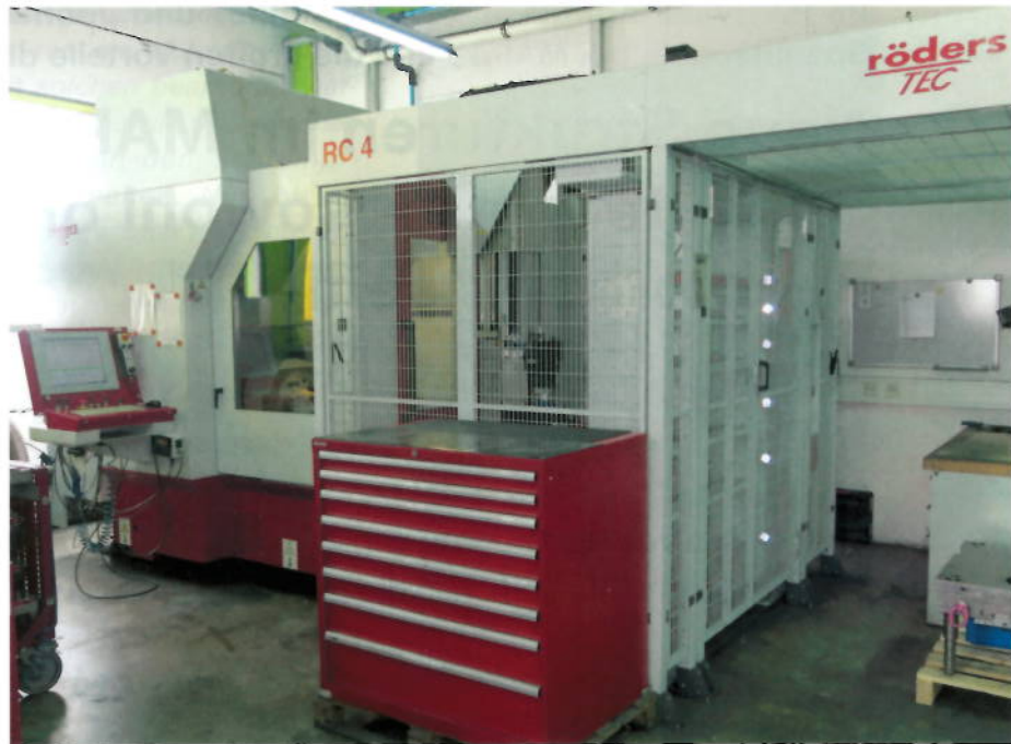
Bild 9: Die fünfachsigige Rödgers RXP 600 DSH mit ihrer Automation RC4 bewährt sich seit 2011 beim Fräsen von Graphit und Werkzeugstahl (Bilder 1 bis 5, 9: appex)
