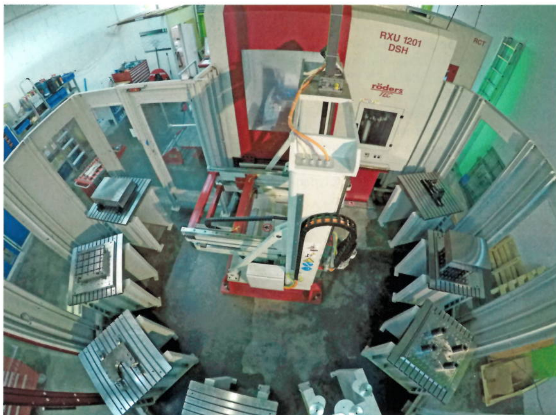
Bild 4: Mit dem Palettenwechsler RCH2 mit ins- gesamt sieben Plätzen kann das Fräsbearbei- tungszentrum an Wochenenden 60 Stunden ohne Unterbrechung durdarbeiten
